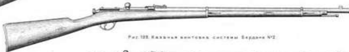
Рис. 188. Драгунская винтовка системы Бердана №2.
