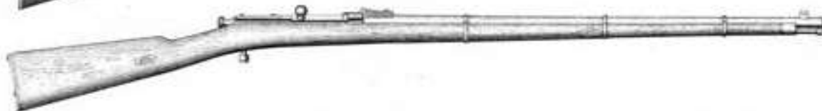
Рис. 189. Казенная винтовка системы Бердана №2.
